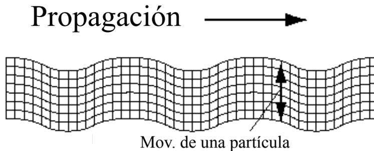
Figura 5.6: Esquema de ondas transversales en un sólido
