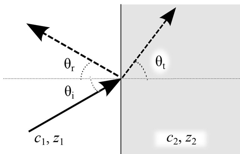
**Figura 5.8:** Onda acústica incidiendo oblicuamente sobre la frontera de separación de dos medios, con las ondas reflejada y transmitida. En esta figura  $c_2 > c_1$ .
