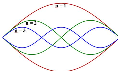
**Figura 5.3:** Representación de los tres primeros modos de vibración de una cuerda
